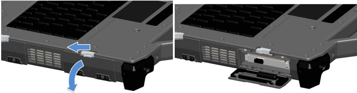
**📎 NOTA:** consulte las instrucciones de desmontaje del disco duro que aparecen en la pegatina de la cara frontal del disco.
