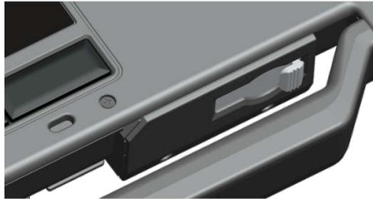
Para abrir la cubierta digital de seguridad, deslice el cierre hacia la izquierda. Para cerrar, deslice el cierre hacia la derecha hasta oír un “clic”.
