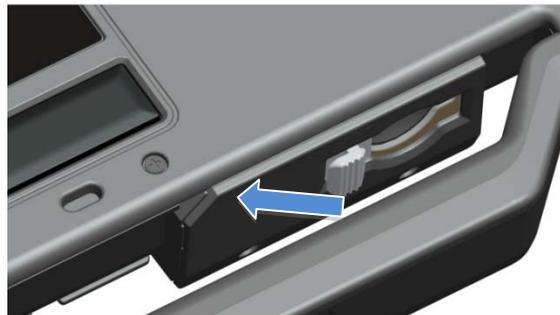
La tarjeta digital de seguridad puede introducirse por completo, permitiendo el cierre de la cubierta de protección. Introduzca la tarjeta en la ranura digital de seguridad hasta que quede completamente asentada en su conector. Para liberar la tarjeta digital de seguridad, presione el borde de la tarjeta y el lector la expulsará.
